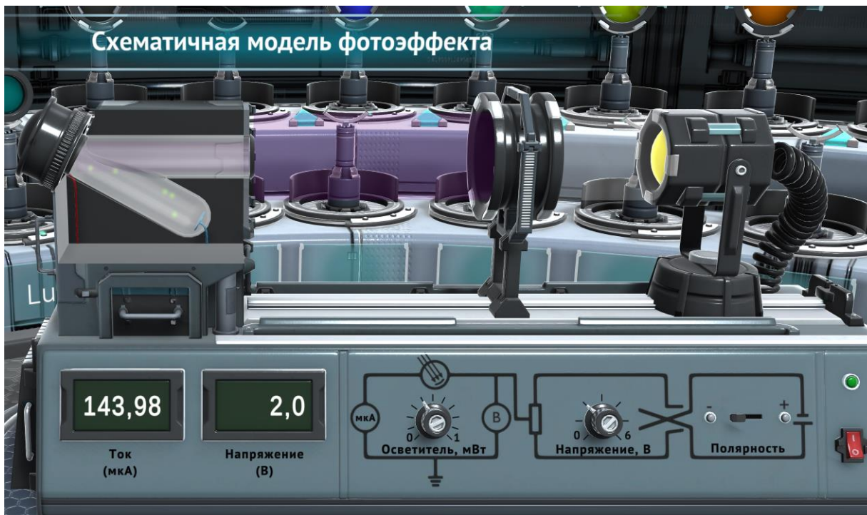
Рисунок 16 – Наблюдение фотоэффекта на установке Столетова
